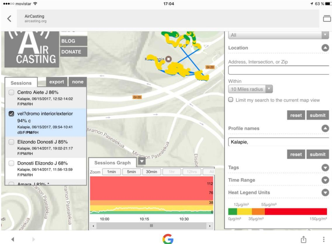
Los niveles de partículas PM2.5 encontrados en la medición continua realizada entre las 9.55 y 10.45, se pueden ver claramente en el gráfico de la parte inferior de la imagen adjunta.
